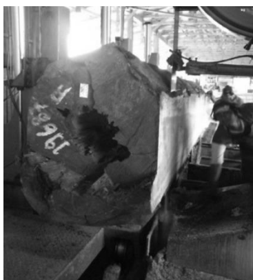
Figura 3. Desdobro principal na serra de fita para toras com defeitos. Figure 3. Defective logs breakdown using a band saw.
