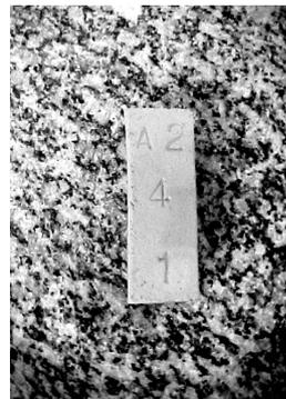
Figura 2. Marcação e numeração dos corpos de prova.
