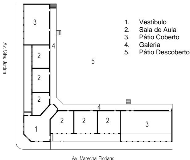
FIGURA 3 - PLANTA BAIXA DO GRUPO ESCOLAR DR. XAVIER DA SILVA FONTE: Coordenadoria do Patrimônio – Secretaria de Administração do Paraná
