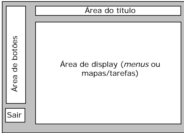
Figura 2 – Layout definido para o protótipo com a indicação das áreas da tela
