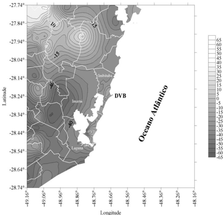
Figura 4 – Modelo de distúrbios da gravidade (em mGal) na região do DVB baseado no modelo do geopotencial **EIGEN-GL04C** (Fonte dos dados: GFZ Potsdam).
