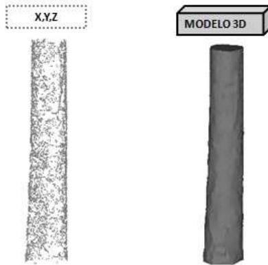
Figura 14 - Nuvem de pontos filtrada e modelo tridimensional (TIN) da primeira tora.
