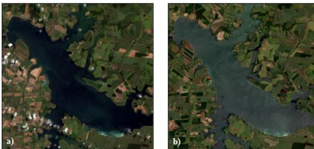
Figura 3. Imagens Landsat-8/OLI. (a) composição colorida RGB 432, 02/04/2014, vento de 1,5 m/s (INMET) sem efeito de sunglint e (b) composição colorida RGB 432, 09/11/2013, vento de 2 m/s (INMET) com efeito de sunglint.
