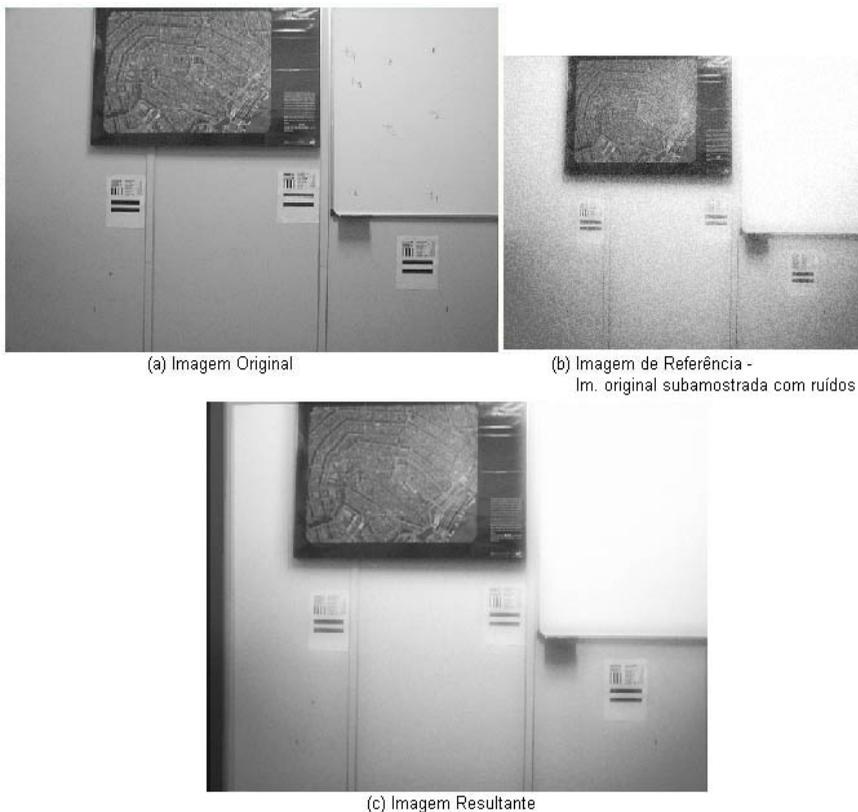
A figura 3 mostra o resultado do melhoramento de resolução a partir do registro pela transformação *projetiva* e fusão pela *média* de uma seqüência com oito imagens com pequenos deslocamentos e ruídos adicionados por software. A imagem mostrada em 3(a) é a imagem original; na figura 3(b) mostra-se a imagem subamostrada e acrescida de ruídos, usada como a imagem de referência da seqüência; na figura 3(c) mostra-se a imagem resultante, podendo-se verificar o
