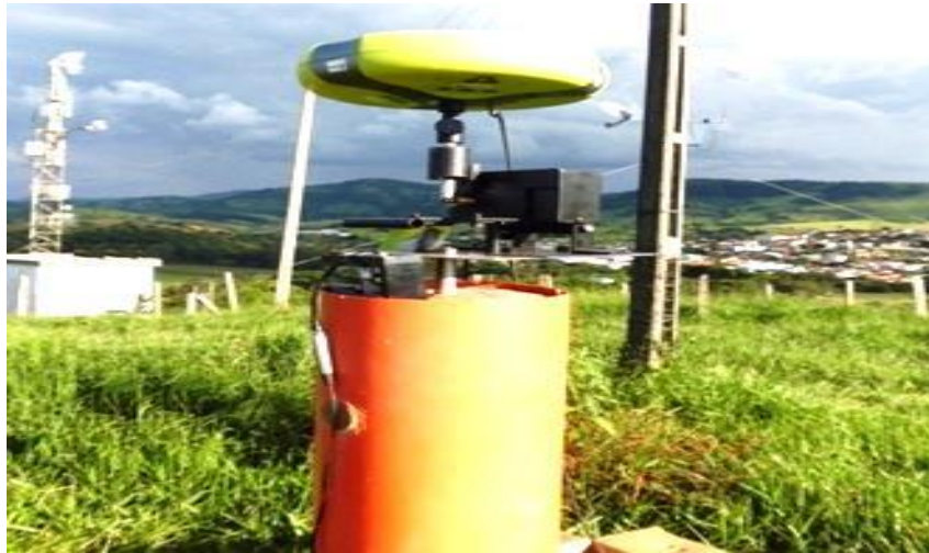
Figura 10: Antena GPS sobre o Oscilador Eletromecânico e Pilar do IBGE no IFSULDEMINAS – Campus Inconfidentes.
