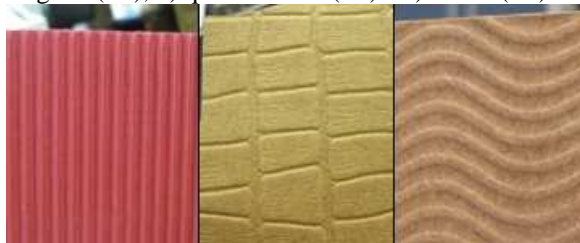
Figura 1 - Texturas usadas na produção artesanal de materiais táteis: a) corrugado (T1), b) quadriláteros (T2) e c) ondas (T3).
