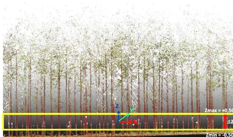
**Figura 2:** Recorte da seção transversal da nuvem de pontos de uma parcela
