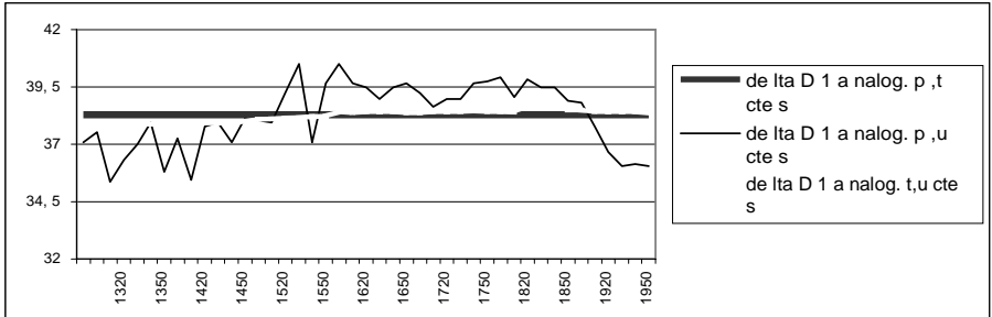
FIGURA 4 - COMPARAÇÃO DAS CORREÇÕES AMBIENTAIS USANDO VALORES MÉDIOS PARA DOIS PARÂMETROS E VARIANDO O TERCEIRO PARÂMETRO—INSTRUMENTOS ANALÓGICOS
