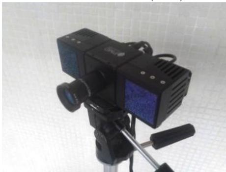
A distância entre o sensor e o alvo é obtida pelo método da diferença de fase, correlacionando o sinal emitido (modulado em amplitude e frequência) e o sinal de retorno ou refletido (demodulado), assumindo que este sinal de retorno possui a forma senoidal. (OLIVEIRA et. al., 2010). O Quadro 1 apresenta as principais especificações técnicas da PMD Camcube 3.0
