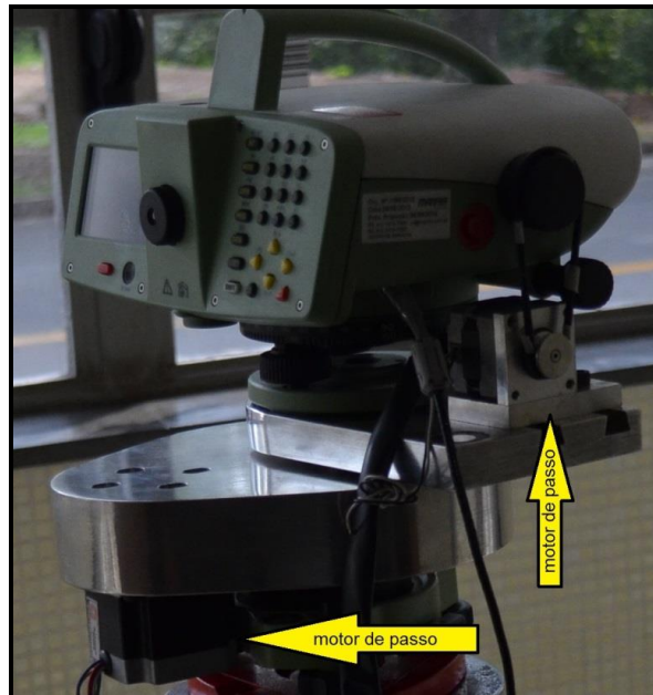
Figura 1: Motores de passo acoplados no DAMP
