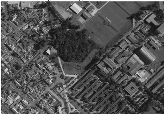
A densidade média de pontos do LIDAR observáveis na imagem resultou 4,0698 pontos/m<sup>2</sup> ou, linearmente, 2,017 pontos/m. É importante salientar-se que se trata de uma aproximação, pois existem várias regiões, dentro da imagem, cobertas por mais do que uma faixa. Os cálculos apresentados enfatizam a melhor resolução da imagem, em relação aos dados do LIDAR, no presente trabalho.
