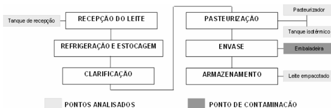
FIGURA 3 - IDENTIFICAÇÃO DOS PONTOS DE CONTAMINAÇÃO NO PROCESSO DE PASTEURIZAÇÃO DO LEITE
