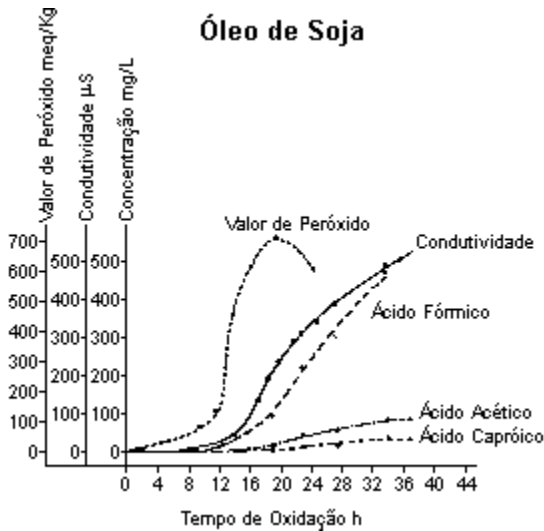
FIGURA 3 - RELAÇÃO ENTRE AS CURVAS DE ÍNDICE DE PERÓXIDO (meq/kg), CONDUTIVIDADE ELÉTRICA ( \mu S) MEDIDA NO RANCIMAT E DE FORMAÇÃO DE ÁCIDOS FÓRMICO, ACÉTICO E CAPRÓICO, DURANTE A OXIDAÇÃO DE ÓLEO DE SOJA
