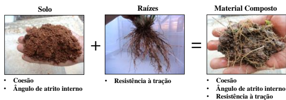
Figura 5. Representação da soma de características que compõem a resistência mecânica do sistema solo-raiz (Fonte: arquivo pessoal do autor).
