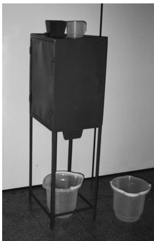
FIGURA 1 – VISTA DA PARTE EXTERNA DO EQUIPAMENTO DE CONTAGEM POR FLUORESCÊNCIA COM LUMINOSIDADE AMARELO-ESVERDEADA - CFLAE
