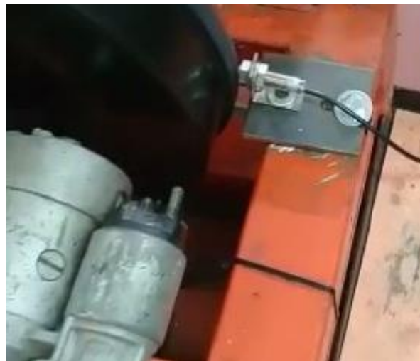
Figura 4. Montaje del sensor inductivo en el banco de pruebas. Fuente: elaboración propia.
