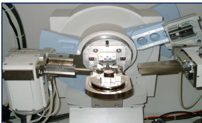
**Figura VII.10.** Difractómetro Multi-propósito PAN analytical modelo X'Pert MPD (UCM)
