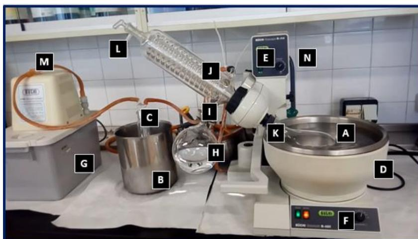
Figura VII.14. Preparación del rotavapor BUCHI B480 vacuum system B-169
