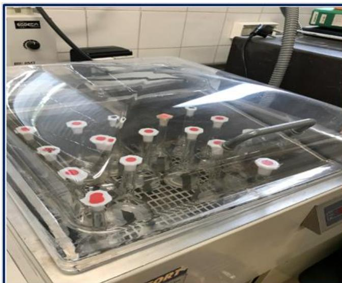
**Figura VII.12. Baño termostatzado con agitación constante HETO® Type SBD50-1 bio. 501828H**
