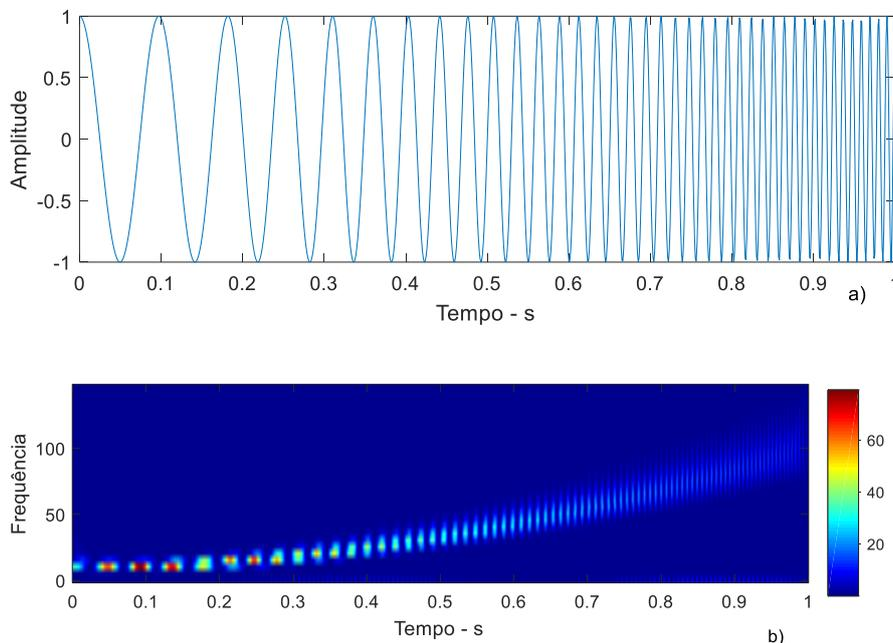
**Figura 5.** a) Sinal quadchirp de frequência variável sem intermitências. b) Transformada de ondaletas do sinal.
