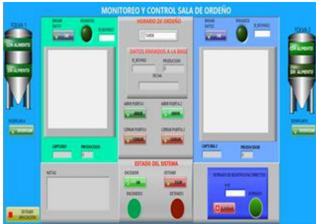
Figura 12. Interfaz de la aplicación creada en Labview
