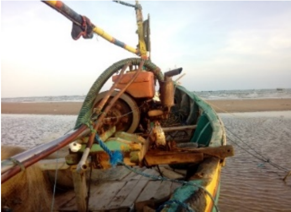
Gambar 1. Motor Diesel di Salah Satu Kapal Nelayan Sampang, Madura
