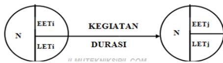
Gambar 1. Diagram CMP untuk satu item pekerjaan
