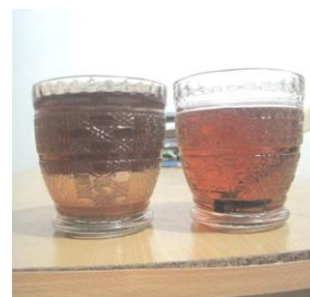
Gambar 16. Solar bersih dan bercampur air
