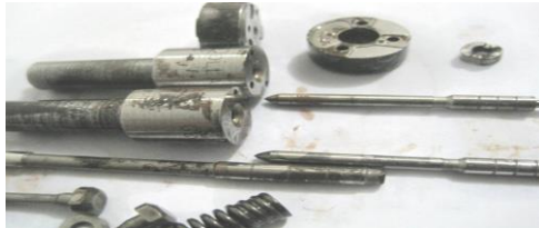
Gambar 19. Komponen injector pada solar yang bercampur air
