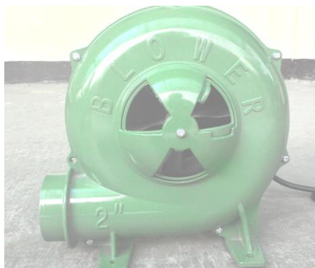
Gambar 6. Blower yang digunakan pada Sistem
