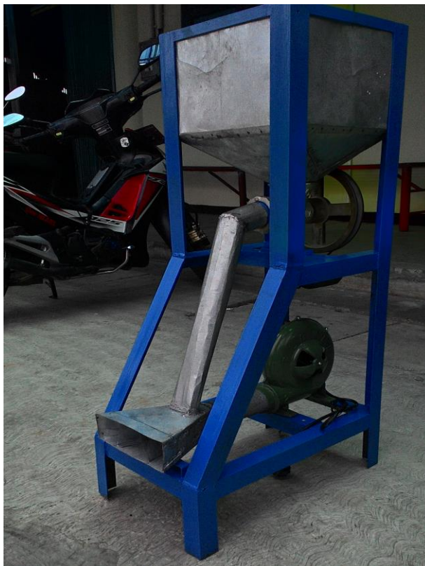
Gambar 3. Alat Penebar Pakan Ikan Hasil Rancangan
