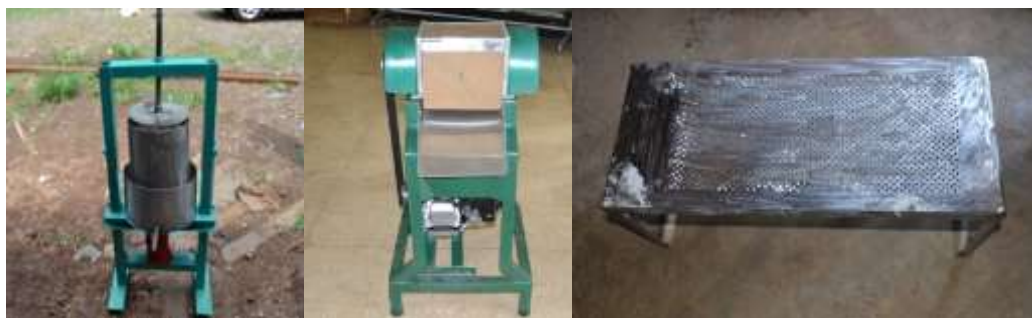
Gambar 1. Alat-alat utama yang digunakan pada pembuatan eyek-eyek ( cassava cracker )
