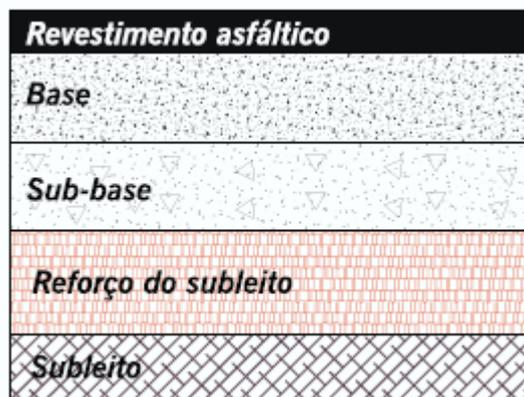
O Pavimento semirrígido é uma mistura dos elementos de algumas das camadas do pavimento rígido e do flexível, sendo ela o revestimento asfáltico e contendo uma porção de base cimentada.
