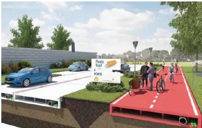
Este tipo de estrutura suporta temperaturas entre  $-40^{\circ}\text{C}$  e  $80^{\circ}\text{C}$  segundo a KWS incorp, além de ser vazado no meio, possibilitando a passagem de fios e tubulações de drenagem, causando um impacto menor no solo. Algumas discussões são levantadas em relação a perda de atrito do material e a geração de um solo mais escorregadio.
