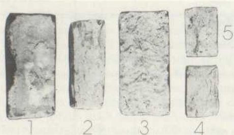
Mittelalterlicher Backstein, Lübeck um 1220. 1. Oberseite handabgestrichen, 2. Seitenansicht mit Quetschfalten, 3. Unterseite mit Planabdruck, 4. Schmalseite (Kopf) mit Quetschfalten, 5. Bruchbild
