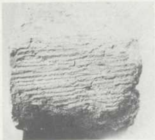
Riefelung auf der abge-schrägten Ansichtsfäche eines mittelalterlichen Backsteins um 1220
