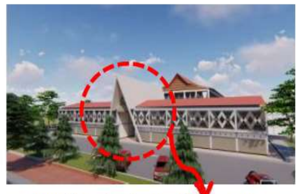
Pengaplikasian bentuk segitiga dan pelana yang berfungsi sebagai atap dan fasade
