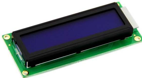
Gambar 2.15. LCD 16x2
