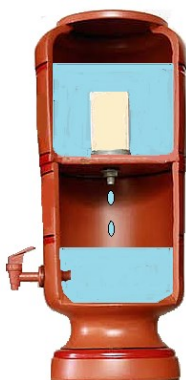
Figura 2. Processo de filtração nos filtros de barro
