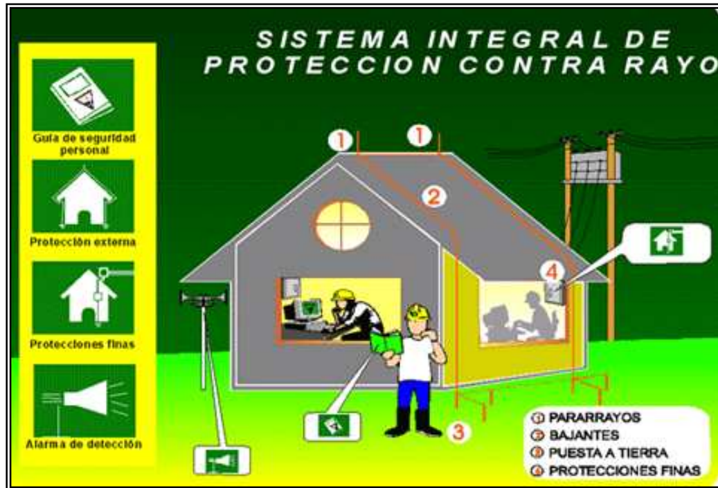
Figura 15. Sistema Integral de Protección contra Rayos
