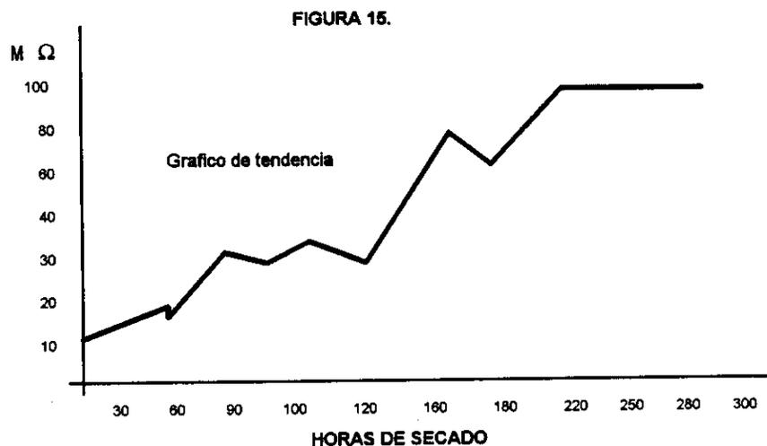
CONTROL DE SECADO MEDIANTE MEDIDA DE LA RESISTENCIA.
