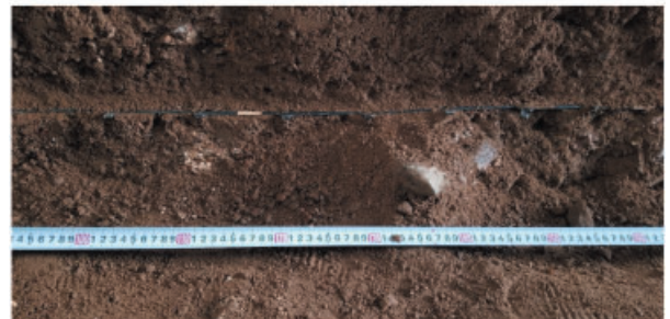
(c) 2 番目のジオグリッドの拡大写真(一段タイプ側)
