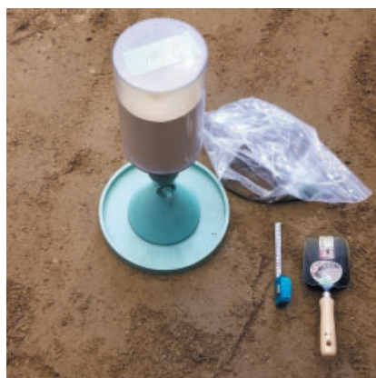
写真 17 砂置換法による測定状況 Photo 17 Measurement status by sand replacement method.
