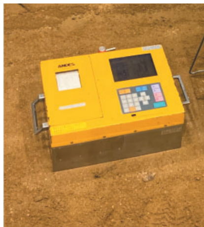
写真 16 RI 計器による測定状況 Photo 16 Measurement using RI instrument.
