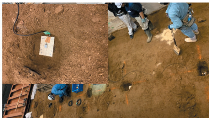
(b) 盛土内部の加速度計
