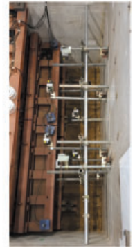
(c) 二段タイプの変位計設置
