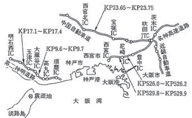
図 14 高速道路盛土被害図 12) Fig. 14 Damage map along highway embankments.
