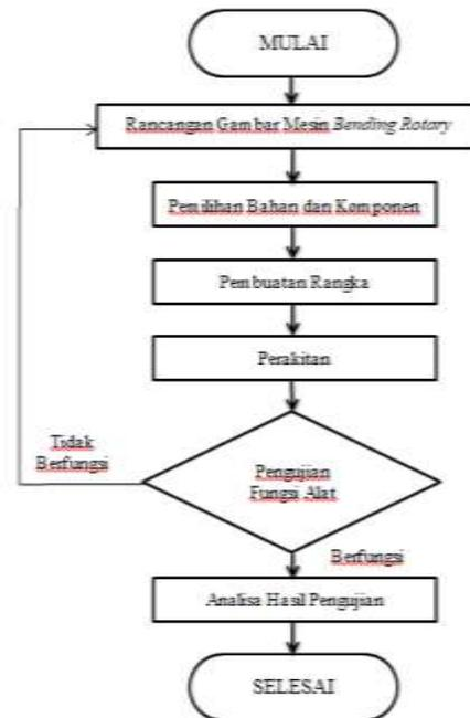
Gambar 2. Diagram Alir Proses Pembuatan
