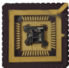
Рис. 12. Чувствительный элемент резонансного типа Fig. 12. The sensitive element of the resonance type
