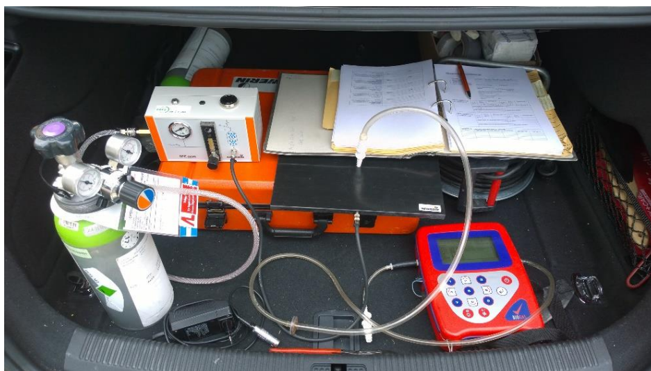
Abbildung 9: Vor-Ort-Kalibrierung des verwendeten Biogasmonitors (vgl. Kapitel 4.2.1)
