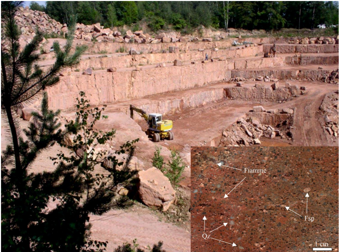
Abbildung 5: Abbau des Rochlitzer Porphyrtuffs im aktiven Steinbruch am Rochlitzer Berg. Ausschnitt rechts unten zeigt einen Anschlag des Rochlitzer Porphyrtuffs mit deutlich sichtbaren Fiamme, Rauchquarz (Qz) und rötlichen Feldspat (Fsp).
