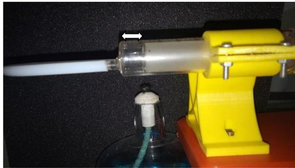
Gambar 8. Piston pada silinder dingin.
