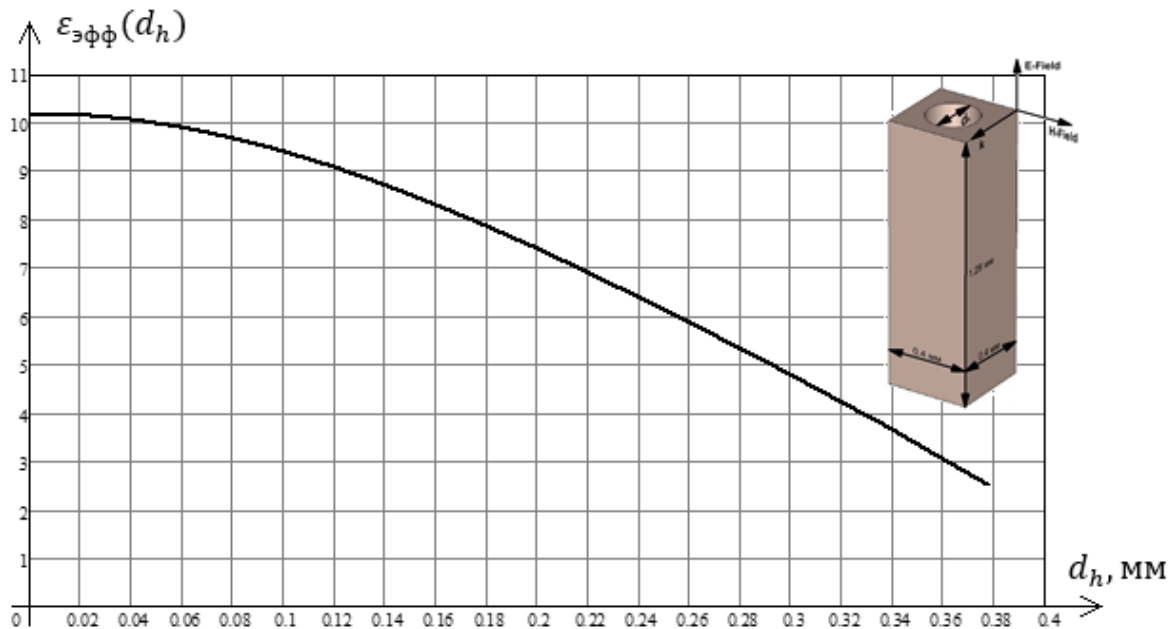
Рис. 21. Зависимость эффективной диэлектрической проницаемости \epsilon_{эфф} ячейки периодической структуры от диаметра сквозного отверстия d_h
