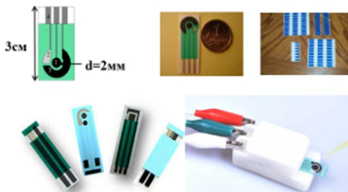
**Рисунок 1.** Дизайн электродов различной конфигурации, получаемых методом трафаретной печати.
