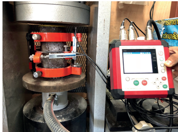
รูปที่ 2 การติดตั้งชุดทดสอบสำหรับการหาค่ามอดุลัสยืดหยุ่นของจีโอพอลิเมอร์มอร์ตาร์
