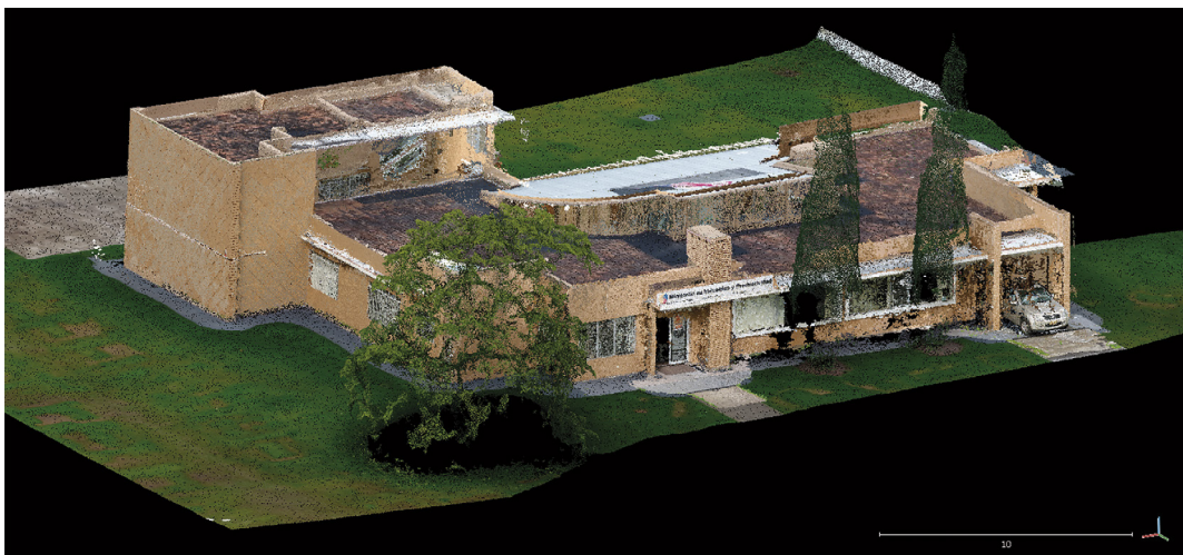
Figura 5: Modelo tridimensional del caso estudio relevamiento mediante fotogrametría
