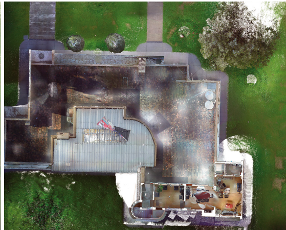
Figura 2. Planta alta del caso estudio relevamiento mediante láser escáner
