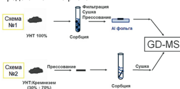
Рис. 3. Различные варианты сорбции урана на сорбенте.
