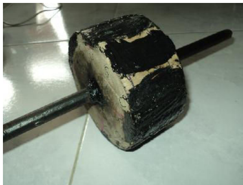
Gambar 2. Rotor dengan magnet Neodymium N50
