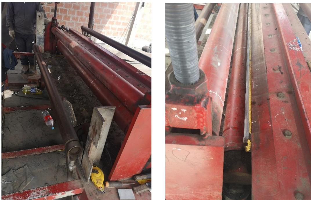
Figura 15 Máquinas cortadoras de caucho.
