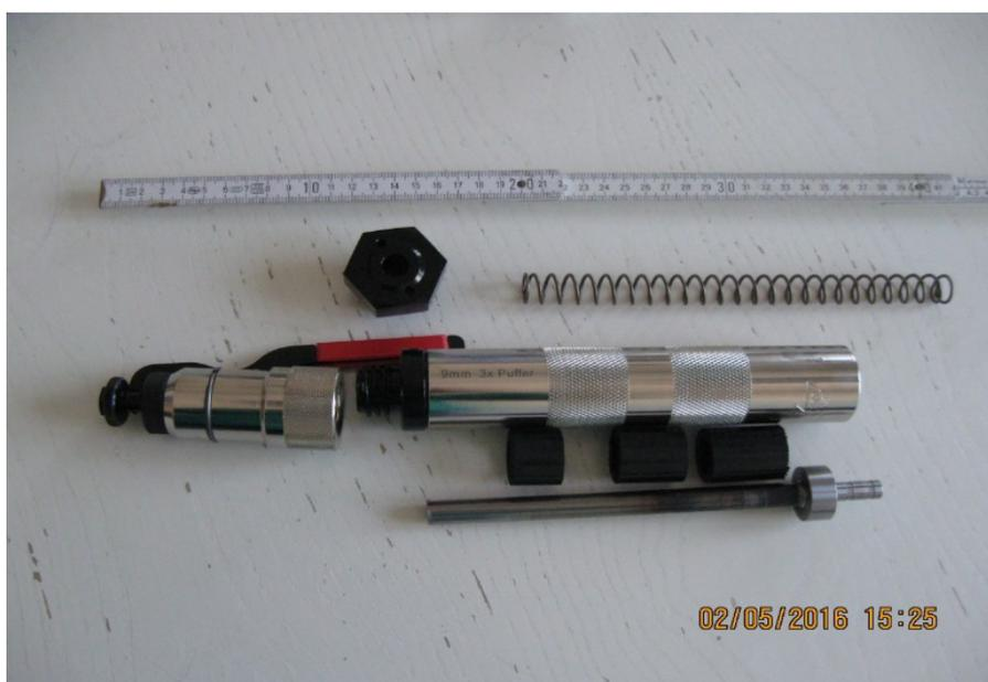
**Abb. 4:** Bolzenschussgerät „Drei Puffer“ mit dreiteiligem Elastomer
