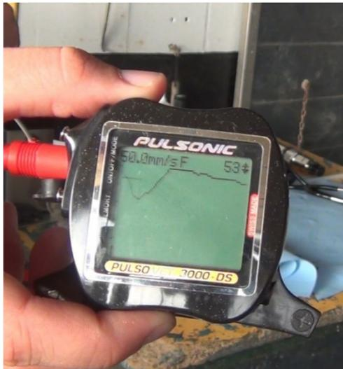
**Abb. 49:** Beispiel für eine Herzstromkurve bewertet mit „Keine Ähnlichkeit mit physiologischer Herzstromkurve“ bei einer angezeigten Herzfrequenz von 53 Schlägen pro Minute (Ableitengeschwindigkeit 50 mm/s)
