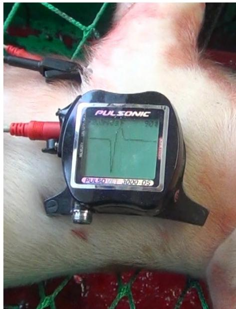
**Abb. 48:** Beispiel für eine Herzstromkurve bewertet mit „Ähnlichkeit mit physiologischer Herzstromkurve“ bei einer angezeigten Herzfrequenz von 90 Schlägen pro Minute (Ableitengeschwindigkeit 50 mm/s)
