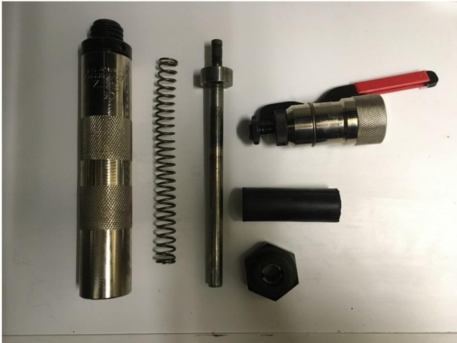
**Abb. 5:** Bolzenschussgerät „Blitz-Kerner“ mit einteiligem Elastomer
