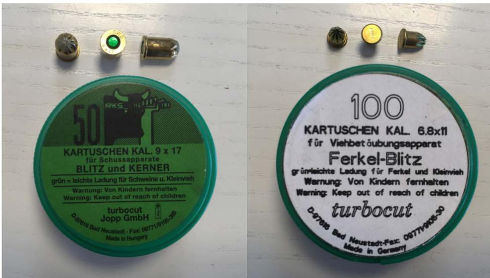
**Abb. 6 und 7:** Serienmäßige Kartuschen für die Geräte „Drei Puffer“ und „Blitz-Kerner“ (links) sowie Spezialkartuschen für das Gerät „Kurze Ausführung“ (rechts)
