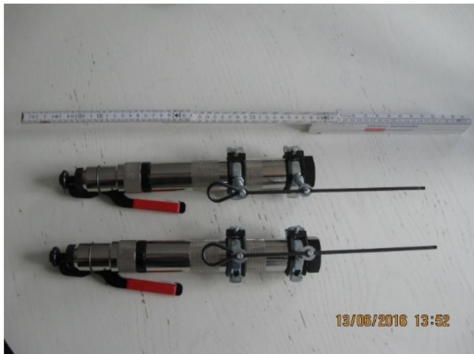
**Abb. 8:** Bolzenschussgeräte „Drei Puffer“ und „Blitz-Kerner“ mit selbstentwickelter Zielvorrichtung bestehend aus den Reinigungsstäben und Schraubzwingen
