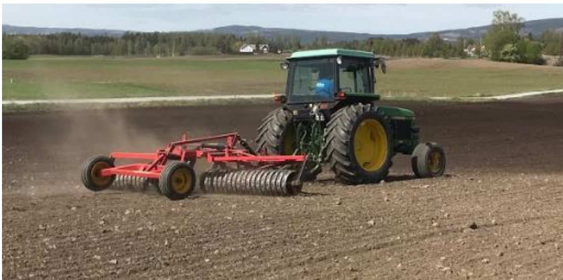
Fig. 3 Tidlig sammenleggbare trommel fra Väderstad med to seksjoner i aksjon på Blæstad. Av forfatteren.
