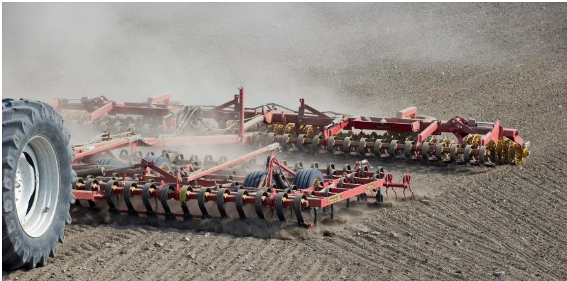
Fig. 13 Originalt ekstrautstyr gjør at såbedsharv og trommel kan kombineres. Foto: Väderstad AB
