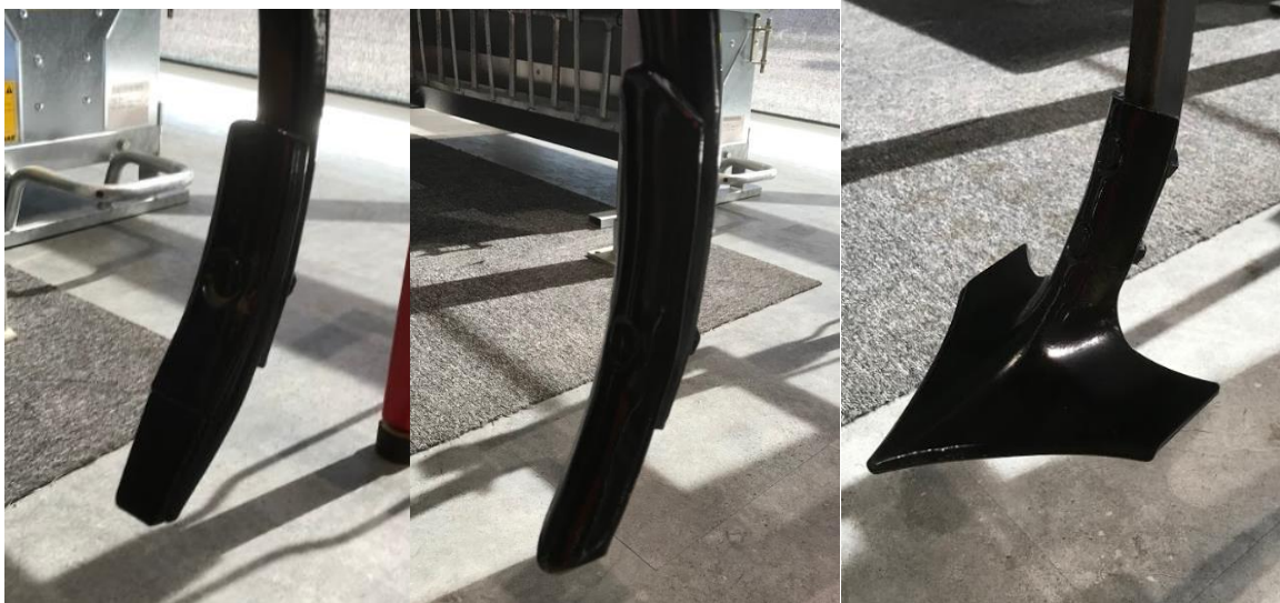
Fig. 29 Väderstad 25/35 spiss, der nedre del er 25 mm mens øvre del er 35 mm. Foto: privat.
