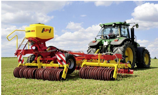
Fig. 12 APV trommel med langfingerharv og såfrøaggregat montert på trommel. Foto: produsenten.
