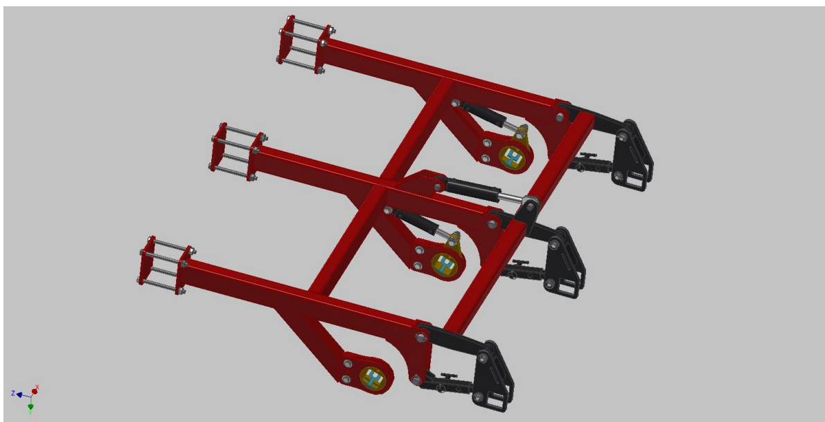
Fig. 73 Feste for begge firkanttrør med spesialskiver og parallellogram. Av forfatteren.
